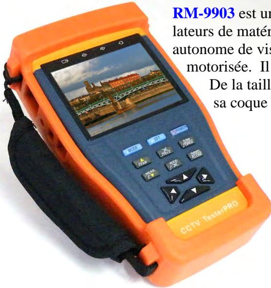
**RM-9903** est un outil polyvalent indispensable aux utilisateurs et installateurs de matériels vidéo. Mais il peut être utilisé comme un terminal autonome de visualisation et de contrôle pour toute caméras fixe ou motorisée. Il fournit en outre une alimentation 12 volt pour caméra. De la taille d'un multimètre, autonome sur sa batterie et protégé par sa coque en caoutchouc antichocs, il possède de nombreux atouts.
