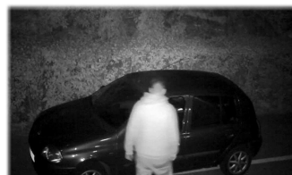
Image nocturne en obscurité totale grâce aux LED infrarouge, portée 8 à 15 mètres.
