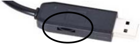
Potentiomètre de réglage d'intensité des LED
