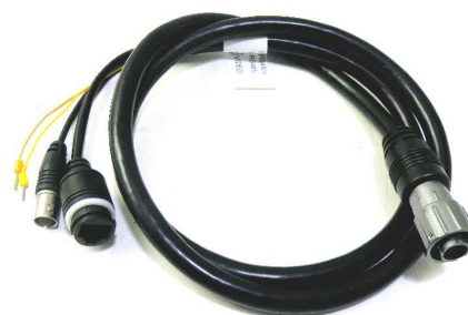
Câble standard 2m avec RJ45 (data & POE) et BNC (Vidéo composite) + 2 fils pour télémétrie RS-485
