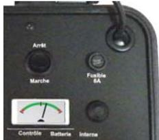
Une batterie tampon intégrée dans la valise VIP permet une utilisation autonome temporaire. Un afficheur LCD indique la capacité restante. La valise est alors dotée d'un régulateur de charge / décharge et elle est fournie avec une alimentation secteur 14V pour fonctionnement en continu sur secteur et recharge de la batterie.
