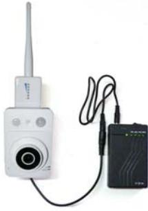
Le transmetteur radio numérique est alimenté en même temps que le bloc caméra auquel il est attaché. Il possède une antenne omnidirectionnelle 6 dBi et une série de voyants indicateurs de niveau de qualité de la liaison HF. Plusieurs types de batteries externes sont proposées pour s'adapter aux différents besoins d'autonomie. Une alimentation 230VAC est livrée en cas de présence de courant secteur localement.
